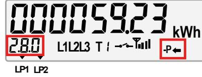
... und **Stromeinspeisung** z. B. durch eine Photovoltaikanlage
